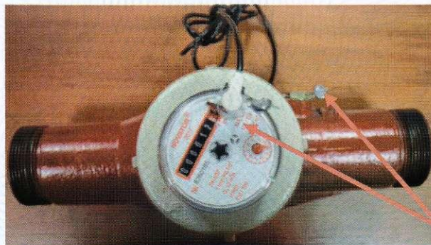
Рисунок 5 - Зовнішній вигляд та місця пломбування лічильника ЛК- ... (модифікації 25Х, 32Х, 40Х, 25Г, 32Г, 40Г) з герконовим датчиком імпульсного виходу
