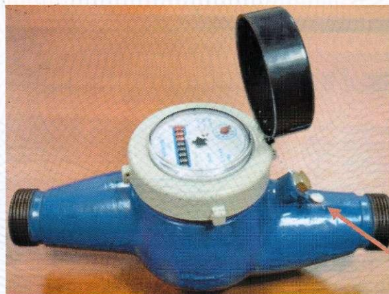
Рисунок 2 - Зовнішній вигляд та місце пломбування лічильника ЛК- ... (модифікації 25Х, 32Х, 40Х, 25Г, 32Г, 40Г)
